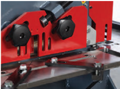
Capacidad de corte de chapa plana 200x15 mm. & 300x12 mm.
