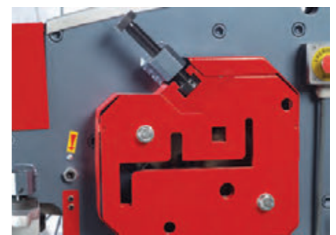
En la estación de cizallado de perfiles se pueden cortar en ángulo gracias a la ejecución especial del útil
