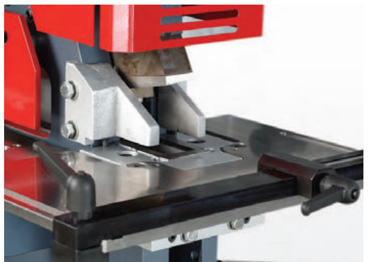
Estación de escantonado
